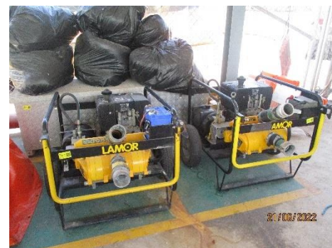
ภาพที่ 2-7 ตัวอย่างอุปกรณ์กำจัดคราบน้ำมัน
